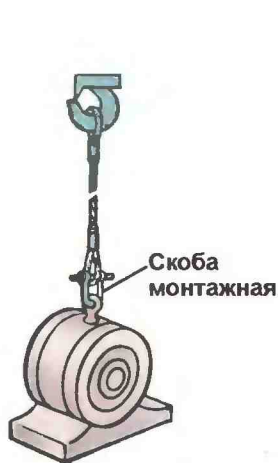
СТРОПОВКА ЭЛЕКТРОДВИГАТЕЛЯ ДВУХПЕТЛЕВЫМ СТРОПОМ
