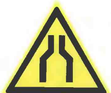
Осторожно. Сужение проезда (прохода)
